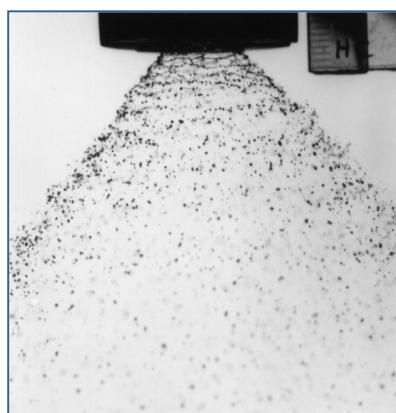
2. kép: Üreges-kúpos fúvóka cseppképzése, 1 % Melius alkalmazásával, 1,5 bar nyomáson
